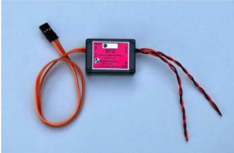
*Dieser elektronische Schalter wurde in erster Linie zur Betätigung von elektrischen Einziehfahrwerken konzipiert. Er eignet sich vorwiegend für die EL-5 / EL-7 und EL-5 Gs Einziehfahrwerke.*
